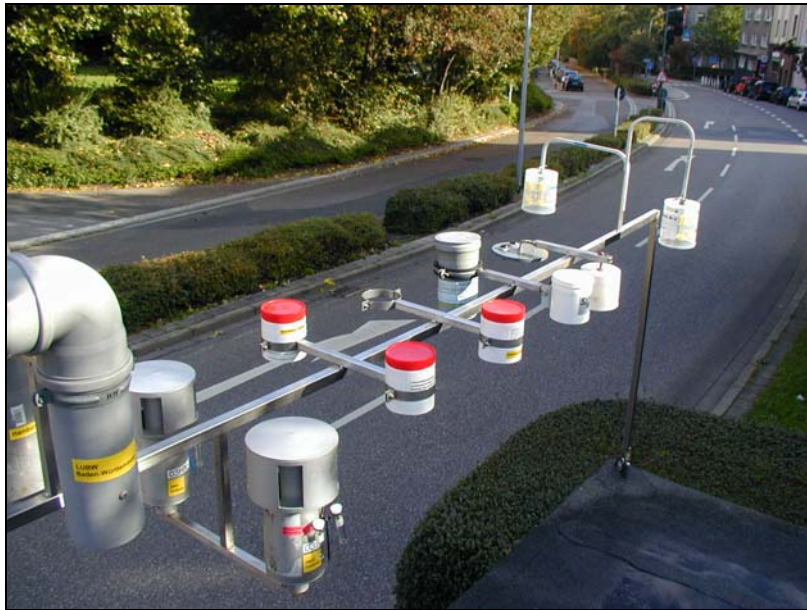
Abbildung 4: Nahaufnahme des Gestells für Probenahmevorrichtungen 1
