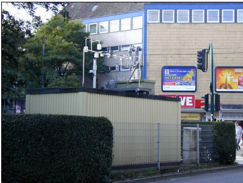
Abbildung 3: Messstation VESN mit Probenahmeverrichtungen für NO 2 -Passivsammler
